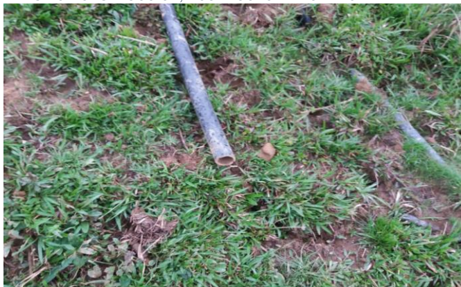
FIGURA 78. MANGUERAS CORTADAS POR OBSTRUCCIÓN, ACUEDUCTO DEL CEDRO
